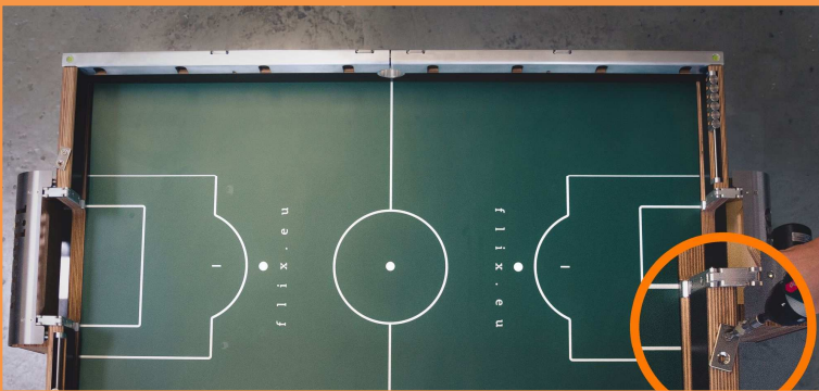
3 Magnet 2 platzieren, mit einer Schraube fixieren
