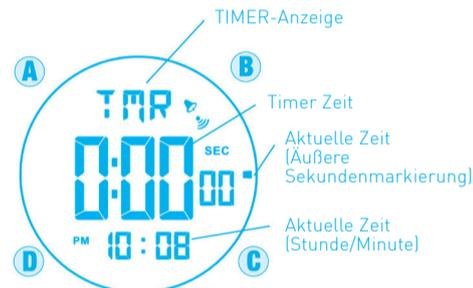
Betätigen Sie den Drucker D zweimal, um in den Timermodus zu gelangen. Die Anzeige für den Timermodus erscheint nun auf dem Display.
