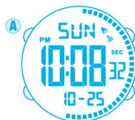
Drücken Sie den Drücker A um die elektronische Displaybeleuchtung für 3 Sekunden zu aktivieren.
