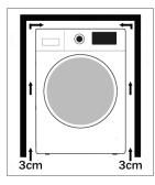
Die Positionierung des Gerätes unter einer Arbeitsplatte kann nur erfolgen, wenn die Mindestabstände entsprechend der Darstellung eingehalten werden können.
