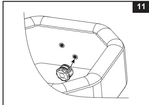
2. Bringen Sie das montierte Gehäuse für die Filterkartusche am Auslassgitter auf der Innenseite der Whirlpool-Wanne an. **Siehe Abb. 11.** Pumpen Sie den Whirlpool auf bevor Sie die Filterpumpe installieren.
