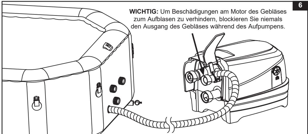
**WICHTIG:** Um Beschädigungen am Motor des Gebläses zum Aufblasen zu verhindern, blockieren Sie niemals den Ausgang des Gebläses während des Aufpumpens.
