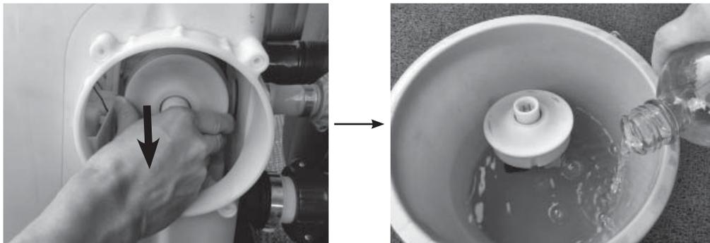
6. Entfernen Sie die Elektrolysezelle und spülen Sie die Titanplatte mit frischem Wasser ab. Geben Sie Acht: Halten Sie den Stecker der Elektrolysezelle vollkommen trocken, achten Sie darauf, dass er nicht mit Essig und Wasser in Berührung kommt.
