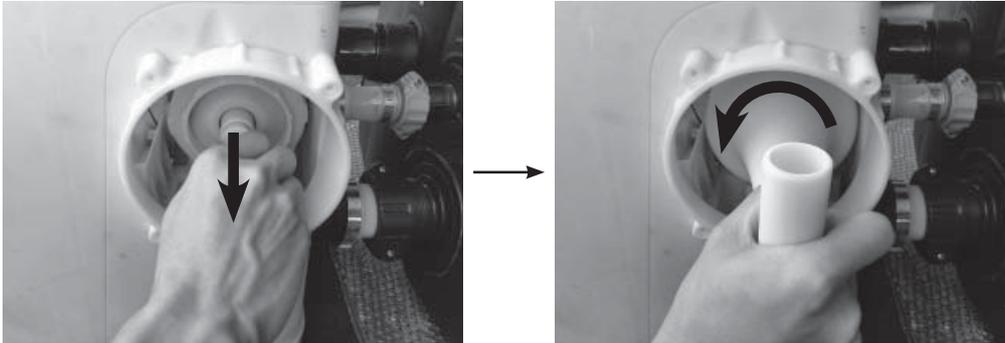
5. Ziehen Sie die Elektrolysezelle heraus und legen Sie sie in einen Kübel. Gießen Sie Essig in den Kübel und weichen Sie die Titanplatte ca. eine Stunde ein, um die Ablagerungen zu lösen.
