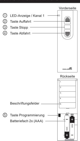
1 LED-Anzeige/Kanal 1 Blinkt während der Programmierung. (2) Taste Auffahrt Rollladen/Markise fährt nach oben/aus Funk-Steckdose / Funk-Lichtschalter/ Funk-Lichtmodul schaltet ein (3) Taste Stopp Stoppt die Fahrt des Rollladens/der Markise. Funk-Steckdose / Funk-Lichtschalter/ Funk-Lichtmodul schaltet aus (4) Taste Abfahrt Rollladen/Markise fährt nach unten/ein
