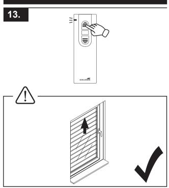
Rohrmotor nicht über Endlagen fahren. Beschädigungsgefahr.
