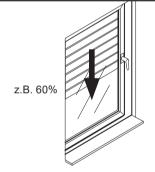
Alle Rohrmotoren (1-5) erhalten die gleiche Zwischenlage und fahren entsprechend.
