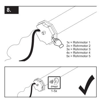
Bis zu 5 Rohrmotoren können pro Kanal angelernt werden. Jeder dieser Rohrmotoren muss eine eigene Adresse erhalten.
