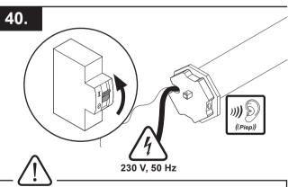
Alle Einstellungen ab Schritt 9 werden gelöscht. Erhalten bleiben die Rohrmotor-Adressen.
