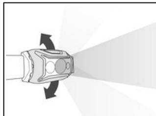
Trägerplatte, die es ermöglicht, den Neigungswinkel der Lampe den Anforderungen entsprechend einzustellen.
