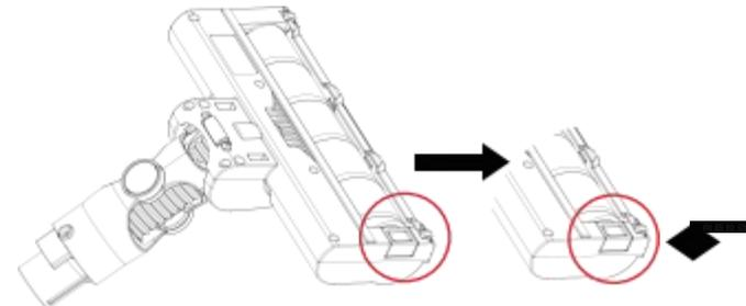
2. Drehen Sie den Seitenteil der Bodenbürste und ziehen Sie die Walze heraus (wie im Bild gezeigt).
