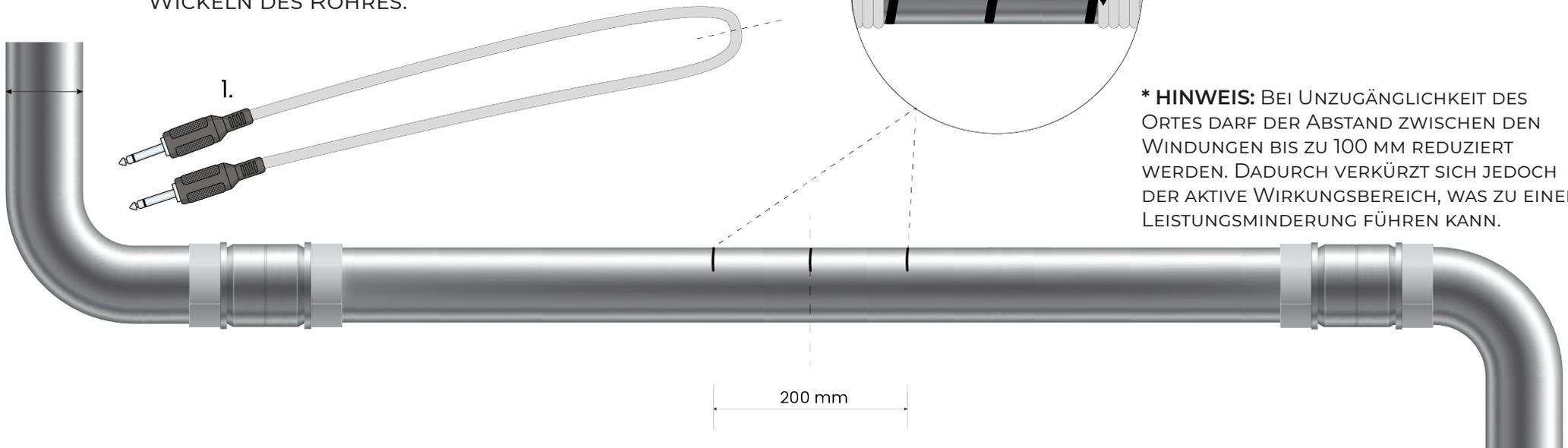
**\* HINWEIS:** BEI UNZUGÄNGLICHKEIT DES ORTES DARF DER ABSTAND ZWISCHEN DEN WINDUNGEN BIS ZU 100 MM REDUZIERT WERDEN. DADURCH VERKÜRZT SICH JEDOCH DER AKTIVE WIRKUNGSBEREICH, WAS ZU EINER LEISTUNGSMINDERUNG FÜHREN KANN.
