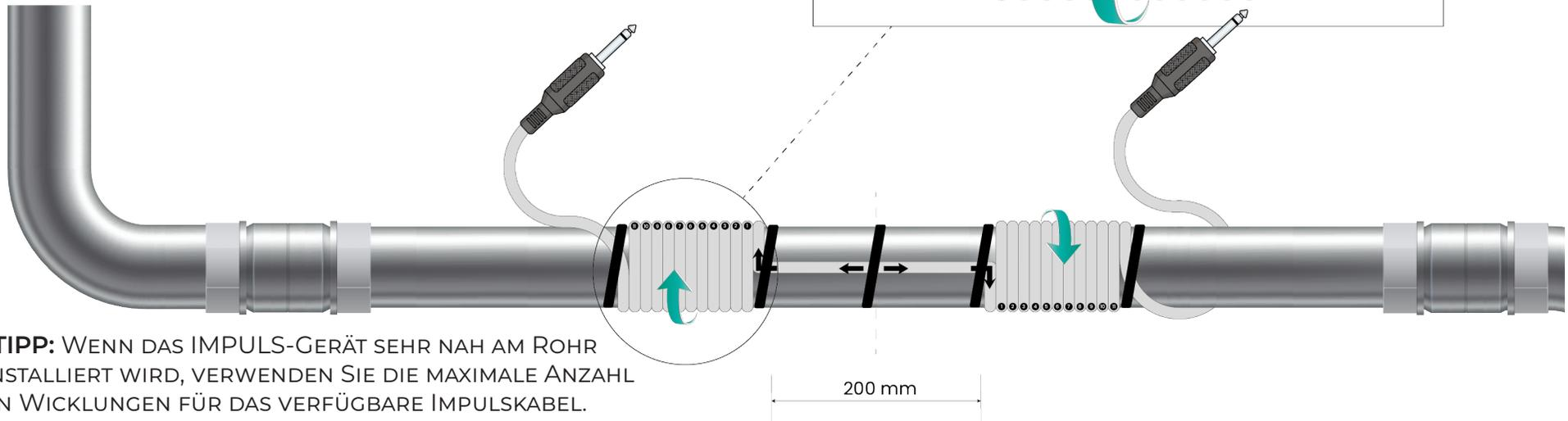
**\*TIPP:** WENN DAS IMPULS-GERÄT SEHR NAH AM ROHR INSTALLIERT WIRD, VERWENDEN SIE DIE MAXIMALE ANZAHL AN WICKLUNGEN FÜR DAS VERFÜGBARE IMPULSKABEL.
