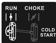
Der Chokehebel muss beim Kaltstart auf Stellung CHOKE positioniert werden. Der Chokehebel muss zum Starten des warmen Motors auf RUN stehen.
