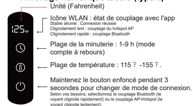
L'appareil fonctionne par défaut pendant 8 heures. Si une durée de chauffage plus longue est nécessaire, réglez la minuterie sur 0 heure. Dans ce cas, le temps de travail maximal est prolongé à 24 heures. Une fois les 24 heures écoulées, l'appareil s'éteint automatiquement pour se protéger. La prochaine fois, la minuterie sera automatiquement réglée sur 0 heure (durée de chauffage de 24 heures).
