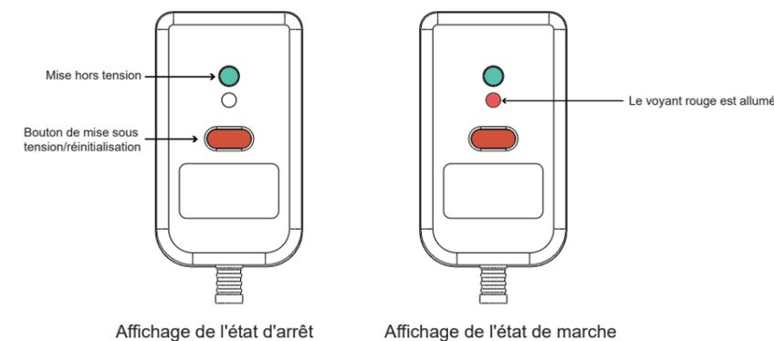
Une fois le porte-serviettes électrique mis sous tension, appuyez d'abord sur le bouton de test (vert) pour le mettre hors tension, puis sur le bouton de réinitialisation (rouge) pour le mettre sous tension.
