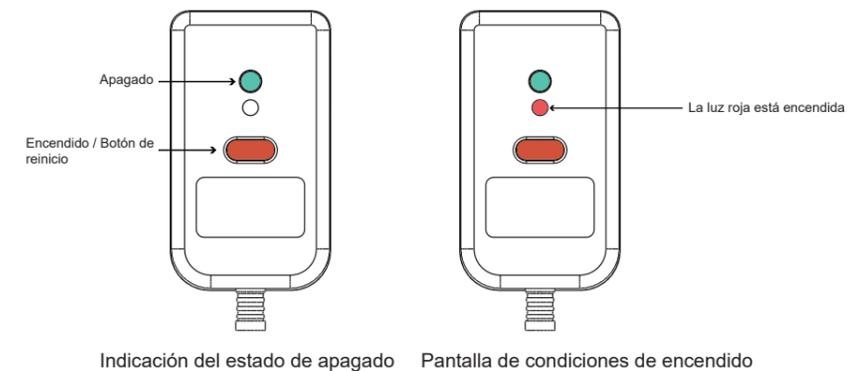
Después de encender el toallero eléctrico, pulse primero el botón de prueba (verde) para apagarlo y, a continuación, pulse el botón de reinicio (rojo) para encenderlo.
