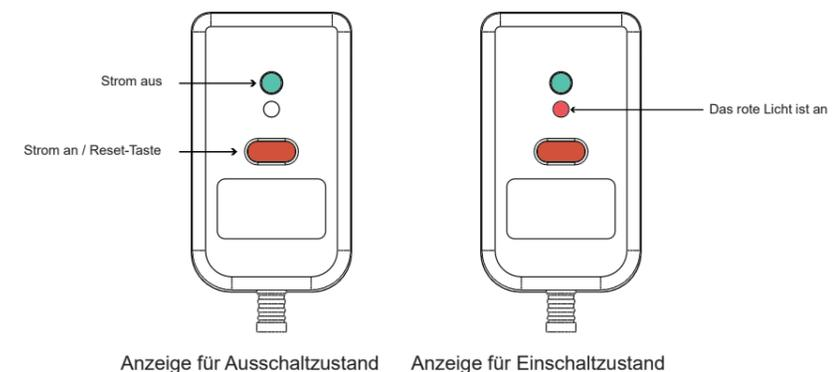
Nachdem das elektrische Handtuchregal mit Strom versorgt wurde, drücken Sie bitte zuerst die Testtaste (grün), um den Strom auszuschalten, und dann die Reset-Taste (rot), um den Strom wieder einzuschalten.
