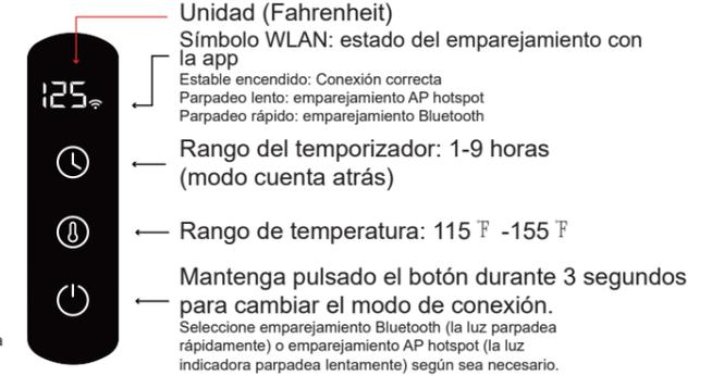
El aparato funciona de serie durante 8 horas. Si necesita un tiempo de calentamiento más largo, ajuste el temporizador a 0 horas. En este caso, el tiempo máximo de funcionamiento se amplía a 24 horas. Transcurridas 24 horas, el aparato se apaga automáticamente para protegerse. El temporizador se ajusta automáticamente a 0 horas la próxima vez (tiempo de calentamiento de 24 horas).
