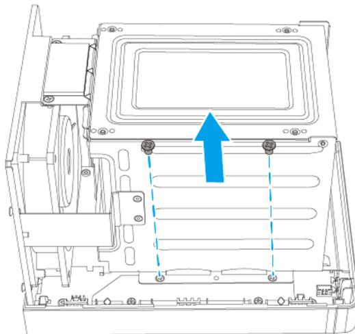
9. Entfernen Sie vorsichtig das Gehäuse des Laufwerkeinsatzes.
