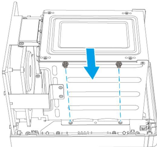
**14.** Schrauben Sie die obere und untere Schraube an der Rückseite des NAS ein.
