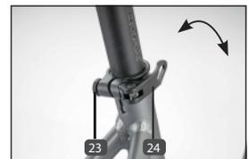
Schließen drücken Sie den Hebel wieder zurück, bis er komplett anliegt. Auf der ersten Hälfte der Schließbewegung muss sich der Hebel relativ leicht, auf der zweiten Hälfte dagegen deutlich schwerer drücken lassen. Sollte dies nicht der Fall sein, muss der Schnellspanner eingestellt werden, da er nicht genügend Spannkraft erzeugt.
