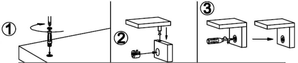
Verwenden Sie zum Festziehen der Nockenschrauben einen Schraubenzieher und keinen Akkuschauber
