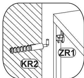
**PL** Załączone kołki do zawieszania bryty, do stosowania wyłącznie do ścian betonowych, do innych ścian należy odpowiednio dokupić.
