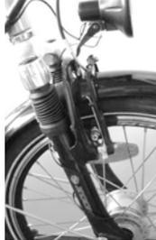
Fourche à suspension réglable avec Lock-Out (verrouillage) et possibilité d'ajustement
