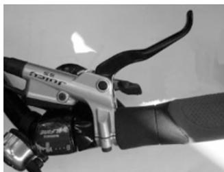
Am Bremshebel befindet sich ein Vorratsbehälter, aus dem per Druck auf den Hebel Bremsflüssigkeit in den Bremszylinder übertragen wird.
