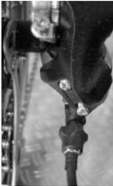
Aanslagschroef „H“ voor kleinste tandwiel
