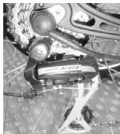
Quand la liberté de mouvement est établie, le réglage affiné survient. Pour cela, passez en 1<sup>ère</sup> vitesse (donc sur le plus grand pignon de la roue dentée) et tournez la poignée de changement de vitesse en position 2 sur la 2<sup>ème</sup> vitesse.
