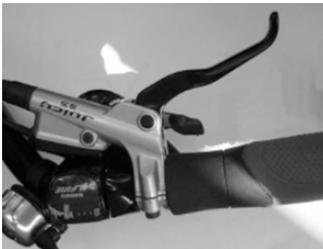
Aan de remhendel bevindt zich een voorraadcontainer waarmee met een druk op de hendel remvloeistof in de remcilinder wordt overgedragen.
