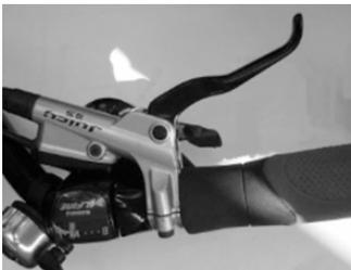
Au levier de frein se trouve un réservoir qui, sur pression du levier, transmet du liquide de freinage au cylindre de freinage.
