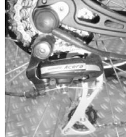
Ist die Freigängigkeit gegeben, folgt die Feineinstellung. Hierzu schalten Sie in den 1. Gang (also auf das größte Ritzel des Zahnkranzes) und drehen dann den Schaltgriff auf Position 2 für den 2. Gang.
