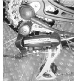
Als de vrije loop gegarandeerd is, volgt de fijninstelling. Hiervoor schakelt u naar de 1<sup>e</sup> versnelling (dus naar het grote tandwiel van de tandkrans) en draait u de schakelgreep naar positie 2 voor de 2<sup>e</sup> versnelling.
