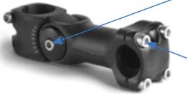
1. Lösen Sie die seitlichen Klemmschrauben des Vorbaus mit einem 4 bzw. 5-mm-Innensechskant-Schlüssel.
