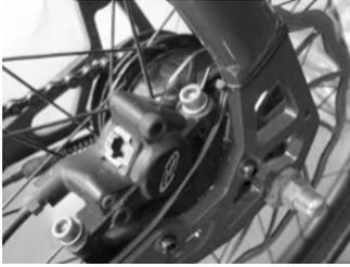
Aan de naaf van het loopwiel is de remschijf bevestigd. Hiermee wordt het remvermogen opgebouwd. Door de dichtheid van de vloeistof is krachtverlies bij dit systeem duidelijk lager dan bij een trekkoordsysteem.
