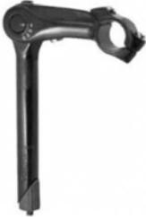
1. Maak de klemschroeven onder de rubberkap van de voorbouw los met een binnenzeskantsleutel van 4 resp. 5 mm.
