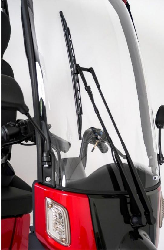
Ein Hauptmerkmal des Deisla DS3-25 ist die elegante Windschutzscheibe aus Glas, die mit einem elektrischen Scheibenwischer und einer Scheibenwischwasseranlage ausgestattet ist.
