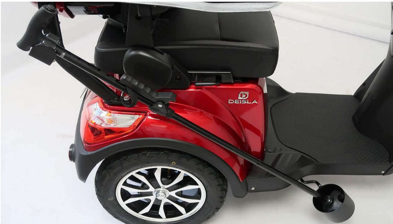
Das Elektromobil ist mit einer praktischen, bereits montierten Stockhalterung ausgestattet. Die Halterung befindet sich auf der rechten Seite (in Fahrtrichtung) hinter dem Sitz, direkt neben dem Heckkoffer. Diese Position ermöglicht einen bequemen und schnellen Zugriff auf Ihre Gehhilfe.
