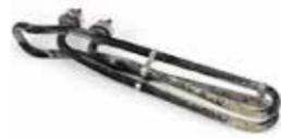
Niedriger pH-Wert und minderwertiges Chlor führen zur Verkalkung des Heizelements
