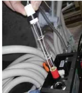
5. Schritt: UV Licht zum Wechselausnehmen
