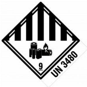
Für den Versand muss der Versandkarton mit dem entsprechenden Gefahrgutsymbol, UN3480 / Gefährdungsklasse 9, versehen sein. Dieses Gefahrgutsymbol muss deutlich, klar erkennbar und unbeschädigt auf dem Versandkarton angebracht sein.
