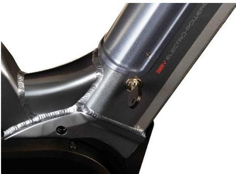
Stecken Sie den Schlüssel in das Schlüsselloch welches sich auf der rechten Seite (in Fahrtrichtung schauend) befindet.
