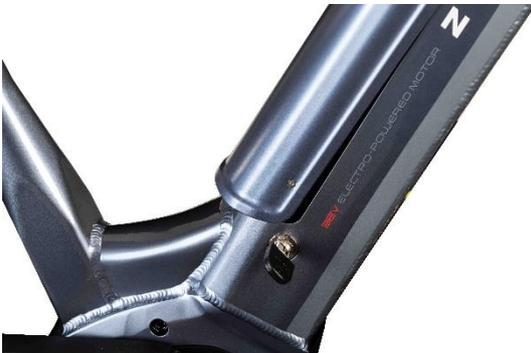
Drehen und halten Sie den Schlüssel links herum (entgegen des Uhrzeigersinns) bis sich die Akku-Abdeckung leicht abhebt. Greifen Sie die Abdeckung und heben Sie diese leicht an bis Sie einen Widerstand spüren. Anschließend können Sie den Schlüssel wieder loslassen. Dieser dreht sich von selber in seine Ausgangsposition so, dass Sie ihn wieder abziehen können.
