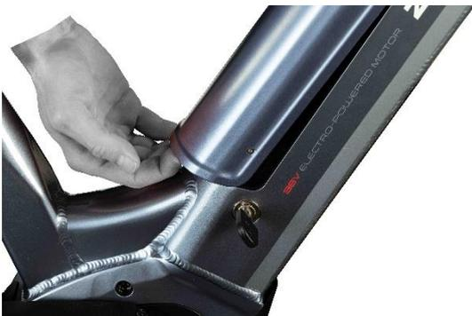
Heben Sie die Akkuabdeckung, wie auf dem Bild links angedeutet, leicht an, drücken Sie die darunter liegende Verriegelung und ziehen Sie den Akku ganz heraus.
