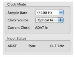
Das erstmalig in der RME Hammerfall eingesetzte Verfahren **SyncCheck** dient der einfachen Prüfung und Anzeige der aktuellen Clock-Situation. Die mit Input Status beschriftete Statusbox zeigt für die Eingänge ADAT, AES und Word Clock getrennt an, ob kein Signal (No Lock), ein gültiges Signal (Lock), oder ob ein gültiges *und* synchrones Signal anliegt (Sync). Im Feld *Clock Mode* wird angezeigt zu welchem Signal die Synchronität besteht (siehe auch Kapitel 38.1).
