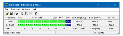
Wird der Messbereich dagegen bei 192 kHz Samplerate auf den Bereich 20 Hz bis 20 kHz begrenzt (sogenannter Audio-Bandpass), ergibt sich wieder ein Wert von -116 dB. Dies ist auch mit DIGICheck nachvollziehbar. In der Funktion **Bit Statistic & Noise** misst DIGICheck das Grundrauschen mit *Limited Bandwidth*, ohne DC und unhörbare hochfrequente Anteile.
