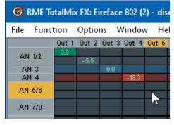
Damit die Übersicht bei verkleinertem Fenster nicht verloren geht, sind die Beschriftungen schwebend umgesetzt, verschwinden also beim Scrollen nicht aus dem Fenster. Ein Rechtsklick der Maus auf diese öffnet das Kontextmenü mit den gleichen Optionen wie in der Mixer View: Copy / Mirror / Paste /Clear input channels und Submixes.
