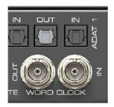
Nach Anwahl der Option *Single Speed* im Settingsdialog (Word Clock Out) wird die Ausgangsfrequenz angepasst, so dass sie immer im Bereich 32 bis 48 kHz ist. Bei 96 kHz und 192 kHz Samplefrequenz wird also 48 kHz ausgegeben.
