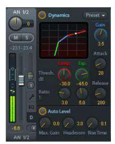
**Release.** Abfallzeit der Regelspannung für Compressor und Expander. Legt die Reaktionsgeschwindigkeit auf abfallenden Pegel fest. Einstellbar von 100 ms bis 999 ms.
