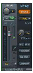
**Loopback.** Sendet die Ausgangsdaten an den Treiber als Aufnahmedaten. Der entsprechende Submix kann dadurch aufgenommen werden. Der Hardwareeingang dieses Kanals sendet seine Daten nur noch an TotalMix, nicht mehr zur Aufnahmesoftware.
