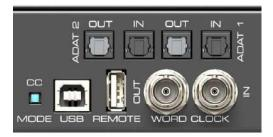
Wordclock I/O. BNC. Über den Settingsdialog kann der Eingang intern mit 75 Ohm terminiert werden.
