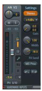
**Width.** Einstellung der Stereo-Basisbreite. 1.00 entspricht vollem Stereo, 0.00 Mono, -1.00 vertauschten Kanälen.
