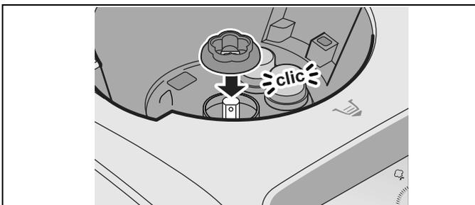
2. Setzen Sie die neue Messeraufnahme **12** auf die Antriebsachse. Die Aussparung in der Messeraufnahme **12** muss dabei passend auf die abgeflachten Seiten der Antriebsachse gesetzt werden. Die Messeraufnahme **12** rastet mit einem „Klick“ auf der Antriebsachse ein.
