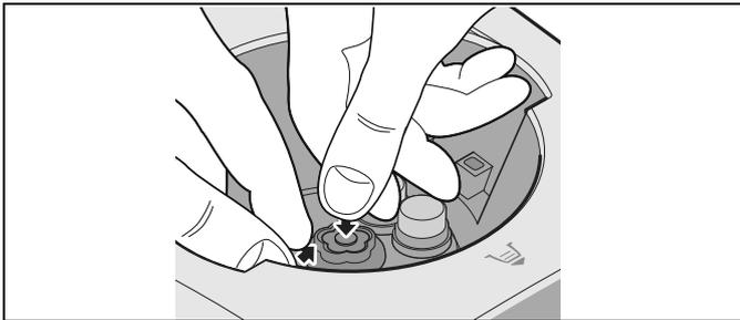
1. Drücken Sie mit dem Daumen auf die Silikon-Abdeckung **26** und greifen Sie gleichzeitig unter den Rand der alten Messeraufnahme **12**. Ziehen Sie die alte Messeraufnahme **12** nach oben heraus. Eventuell müssen Sie ein bisschen „ruckeln“, damit sich die Messeraufnahme **12** herausziehen lässt.
