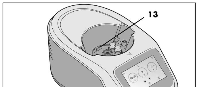
Sollte Flüssigkeit aus dem Mixbehälter **5** austreten, sammelt sich diese nicht im Grundgerät **14**, sondern kann über den Überlauf **13** auf die Arbeitsfläche austreten.
