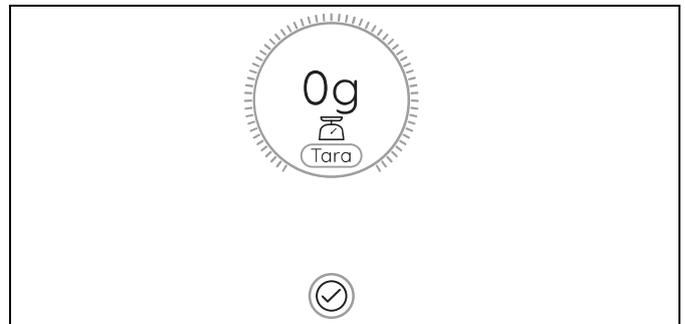
3. Legen Sie das Wiegegut in den Mixbehälter **5**. Im Bildschirm **8** wird das Gewicht bis 5 Kilogramm in Gramm angezeigt.
