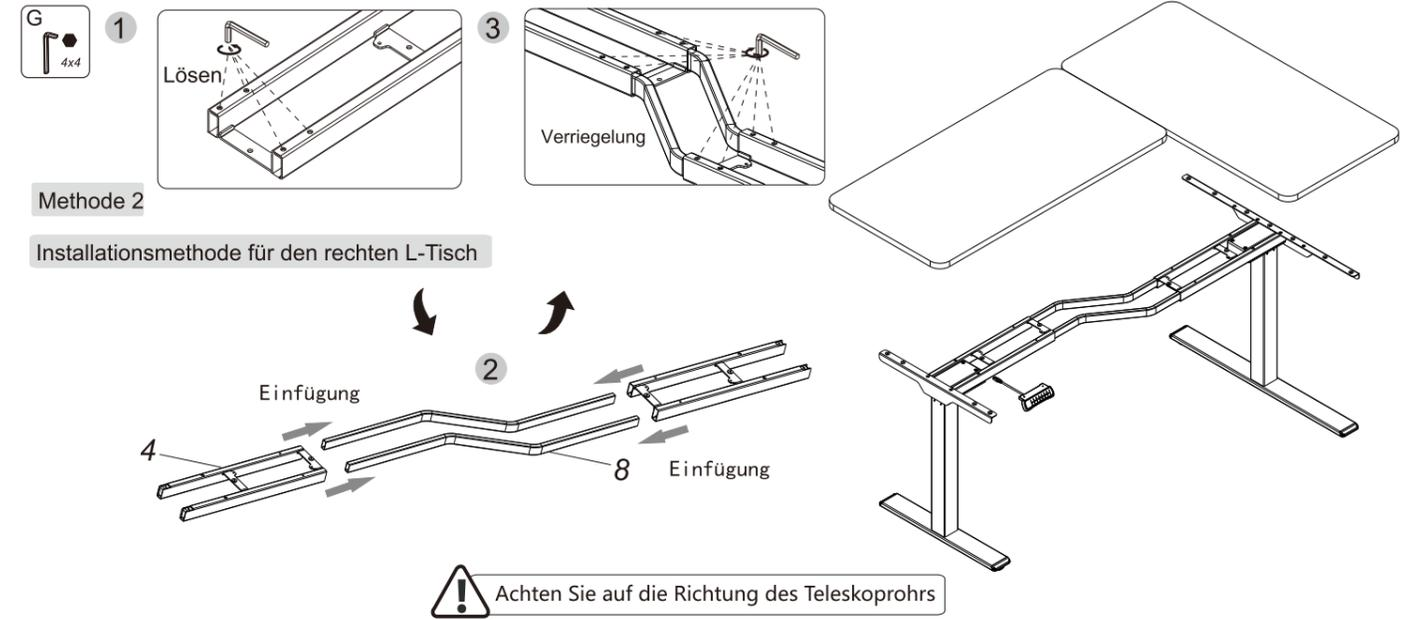
Lösen Sie zuerst die 4 Schrauben am Stützbalken (4), stecken Sie die beiden Enden des Teleskoprohrs (8) in (4) entsprechend der Form der Tischplatte, wie in der Abbildung gezeigt, und ziehen Sie dann die Schrauben fest.
