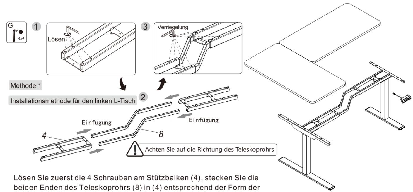
Lösen Sie zuerst die 4 Schrauben am Stützbalken (4), stecken Sie die beiden Enden des Teleskoprohrs (8) in (4) entsprechend der Form der Tischplatte, wie in der Abbildung gezeigt, und ziehen Sie dann die Schrauben fest.
