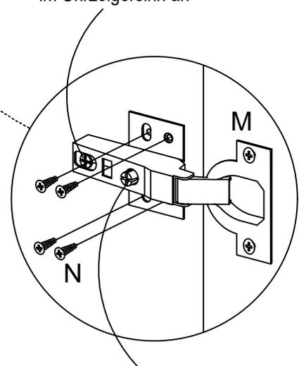
Türverkleidung links und rechts verstellbar, nachdem die Schrauben im Uhrzeigersinn und gegen den Uhrzeigersinn eingeschraubt wurden
