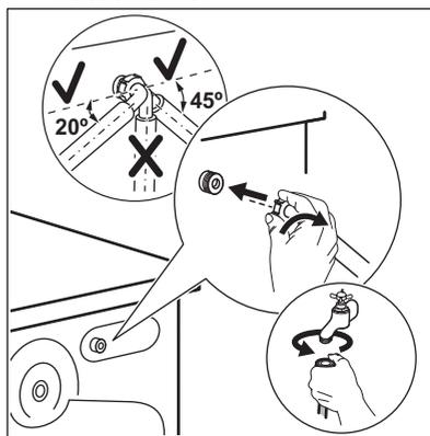
**i** Vergewissern Sie sich, dass sich der Zulaufschlauch nicht in einer vertikalen Position befindet.
