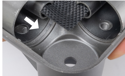
Abb. 6.6.2. Rohre an den Anschlag führen
