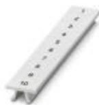
Zackband, Streifen, weiß, beschriftet, beschriftbar mit: CMS-P1-PLOTTER, quer bedruckt: fortlaufende Zahlen 1 ... 10, 11 ... 20 usw. bis 491 ... 500, Montageart: verrasten in hoher Schildchennut, für Klemmenbreite: 6,2 mm, Schriftfeldgröße: 6,15 x 10,5 mm, Anzahl der Einzelschilder: 10
