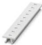
Zackband, Streifen, weiß, beschriftet, beschriftbar mit: CMS-P1-PLOTTER, längs bedruckt: gleiche Zahlen 1 oder 2 usw. bis 100, Montageart: verrasten in hoher Schildchennut, für Klemmenbreite: 6,2 mm, Schriftfeldgröße: 6,15 x 10,5 mm, Anzahl der Einzelschilder: 10
