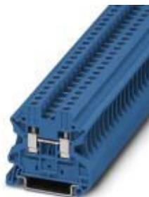
Durchgangsklemme, Nennspannung: 1000 V, Nennstrom: 32 A, Anschlussart: Schraubanschluss, Anzahl der Anschlüsse: 2, Querschnitt: 0,14 mm<sup>2</sup> - 6 mm<sup>2</sup>, AWG: 26 - 10, Breite: 6,2 mm, Höhe: 46,9 mm, Farbe: blau, Montageart: NS 35/7,5, NS 35/15
