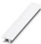
Marker für Klemmen, Streifen, weiß, beschriftet, beschriftbar mit: CMS-P1-PLOTTER, längs bedruckt: U, V, W, N, GND, U, V, W, N, GND, Montageart: verrasten in hoher Schildchennut, für Klemmenbreite: 6,2 mm, Schriftfeldgröße: 6,15 x 10,5 mm, Anzahl der Einzelschilder: 10
