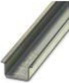
Tragschiene ungelocht, Standardprofil, Breite: 35 mm, Höhe: 15 mm, ähnlich EN 60715, Material: Stahl, verzinkt, dickschichtpassiviert, Länge: 2000 mm, Farbe: silberfarben
