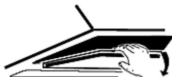
Entfernen Sie den/die Fettfilter. Die Matten werden auf dem Fettfilter befestigt, bzw. an den Seiten des Motors eingeschoben.
