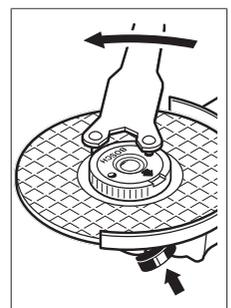
Uma porca de aperto rápido sem danos e bem apertada pode ser solta rodando manualmente o anel serrilhado para a esquerda.
