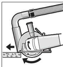
A ferramenta elétrica deve sempre ser conduzida no sentido contrário da rotação. Caso contrário, existe perigo de a ferramenta ser pressionada de forma **descontrolada** sobre o corte. Ao separar perfis e tubos quadrados comece de preferência na seção transversal mais
