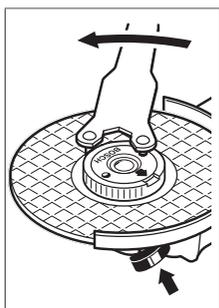
Una tuerca de fijación rápida en buenas condiciones y correctamente fijada, la puede soltar girando el tornillo moleteado con la mano en contra del sentido de giro de las agujas del reloj. **No suelte nunca una tuerca de fijación rápida inmovilizada con unas tenazas, sino utilice la llave de dos pivotes.** Aplique la llave de dos pivotes como se muestra en la imagen.
