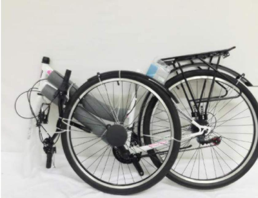
Nachdem lösen der Kabelbinder die Schutzkappe am Rad nach links drehen und entfernen
