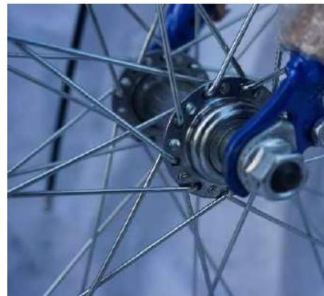
Vorderrad in der Mitte festhalten und Mutter erst nach rechts drehen, dann nach links drehen. (Gleichmäßig festdrehen).Manchmal passiert das die Unterlegscheibe nicht in das Loch am Gabel passt In solche situationen kann man die unterlegscheibe mit den haken nach unten drehen oder fallen lassen und mutter festziehen . (Es können produktionfehler sein bei der Unterlegscheibe das es leicht verzogen ist )
