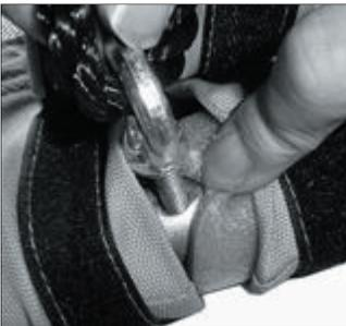
9. Montieren Sie den Schraubbolzen am Rahmenrohr.
