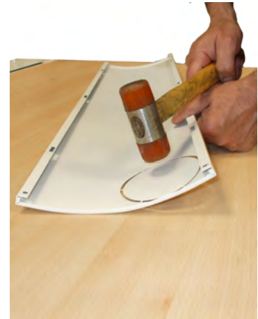
Fig. 30 - Öffnen Sie das Loch (Modell Sfera 3 Plus)
