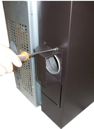
Fig. 50 - Montage der Austrittsdüse
