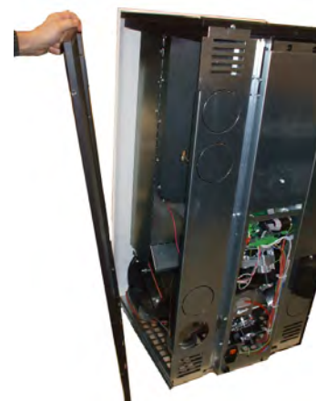
Fig. 63 - Abnehmen der Seitenwand
