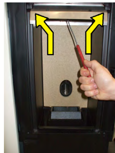
Fig. 78 - Beide Rohre reinigen
