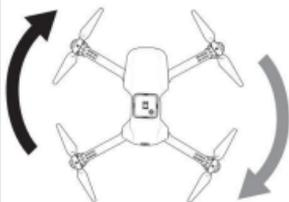
Drücken Sie den Gashebel auf links und rechts, und das Flugzeug wird nach links drehen/ rechts entsprechend der Joystick-Steuerung.
