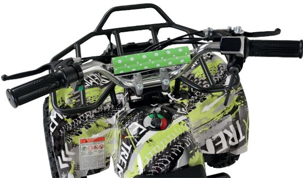
3. Montage des Lenkers mithilfe der 4 Halbmondartigen Metallteile und der beiliegenden 4 Schrauben.
