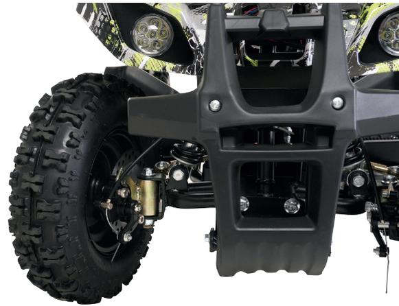
2. Anschrauben der Räder an die beiden Querlenker der Vorderachse.
