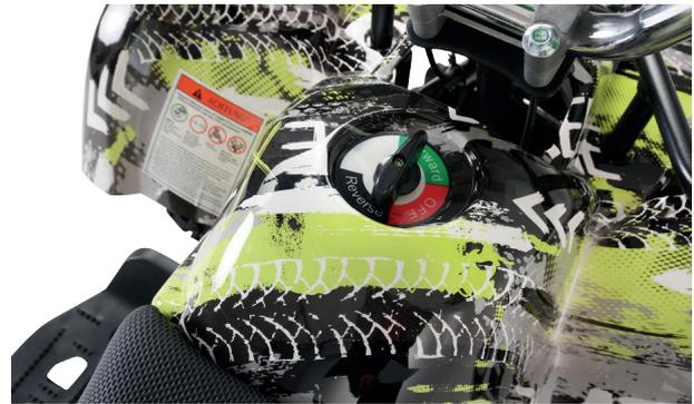
Der Fahrtrichtungsschalter bestimmt die Fahrtrichtung. Der Gasdrehgriff die Geschwindigkeit. Sobald eine Bremse betätigt wird, bleibt das Fahrzeug stehen.
