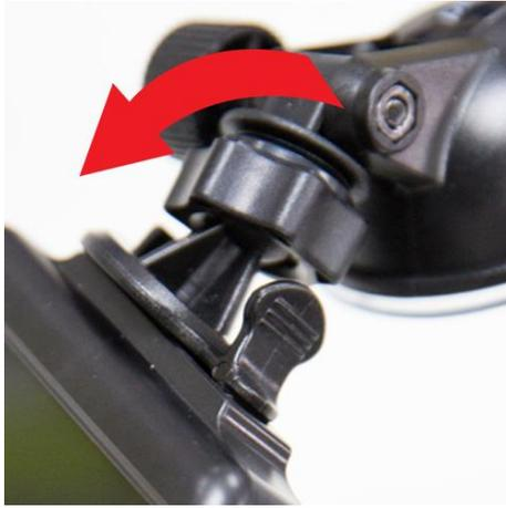
5. Wenn Sie die ideale Position eingestellt haben, drehen Sie die Feststellschraube im Uhrzeigersinn, um die DrivePro zu arretieren.
