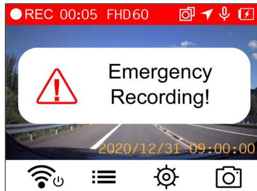
**G-Sensor (Erschütterungs-Sensor) Notfall-Aufnahme:** Wenn die DrivePro während der Aufzeichnung einen Aufprall feststellt, aktiviert die Kamera mit dieser Einstellung automatisch den Notfall-Aufnahmehodus.
