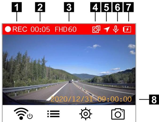
Wenn Sie den Motor starten, schaltet sich die DrivePro ein und beginnt automatisch mit der Aufzeichnung. Es ist voreingestellt, dass pro 60 Sekunden Aufnahmedauer eine Videodatei gespeichert wird. Um die Länge der Aufzeichnung individuell anzupassen, konsultieren Sie bitte den Abschnitt **Einstellungen** in diesem Benutzerhandbuch.
