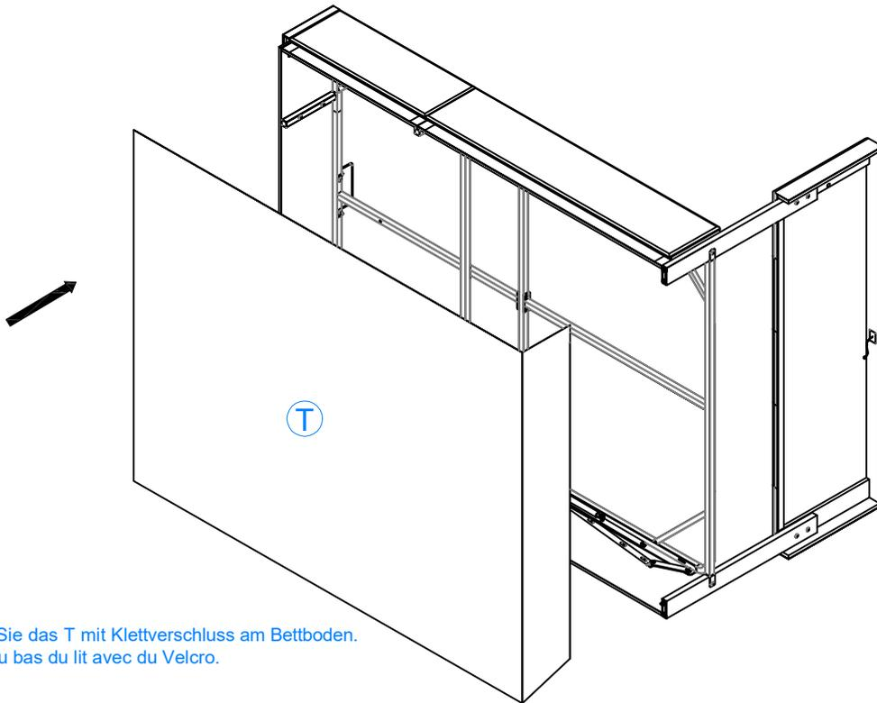
Befestigen Sie das T mit Klettverschluss am Bettboden.
