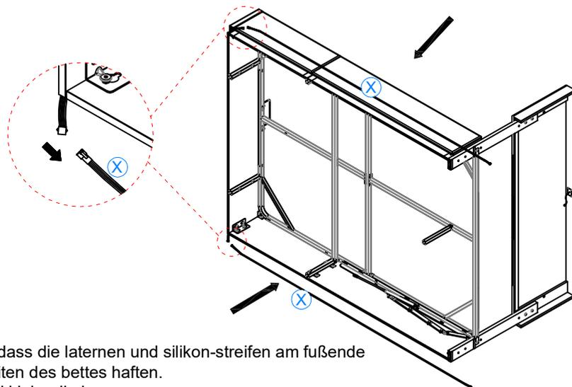
1. Der erste schritt ist sicherzustellen, dass die laterne und silikon-streifen am fußende und die silikon-streifen an beiden seiten des bettes haften.
