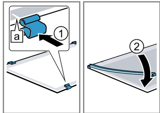
3. Die Zwischenscheibe mit Abstandshalter und Dichtungen in Pfeilrichtung einsetzen ①. Der Pfeil auf der Zwischenscheibe muss mit dem Pfeil auf dem Rahmen übereinstimmen [a].
