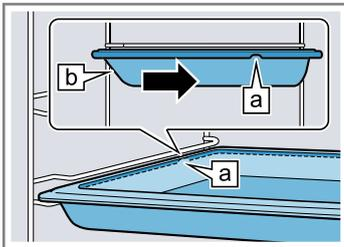
3. Rost oder Blech Das Zubehör so auflegen, dass der Zubehörrand hinter der Lasche [a] auf der Auszugsschiene sitzt.
