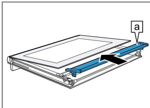
8. Die Innenscheibe mit der Halterung **a** in die Öffnung einsetzen.
