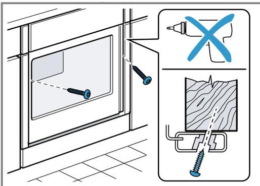
9. Die Gerätetür etwas öffnen, die Blenden anlegen und zuerst oben, dann unten festschrauben.
