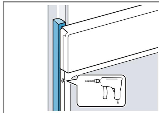
4. Das Gerät mit adäquater Schraube befestigen.
