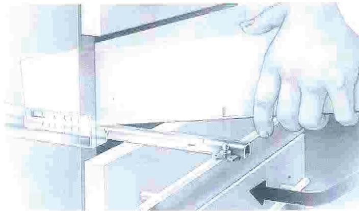
Der Schubkasten wird durch den Aufsteckzapfen vorn positioniert, wobei sich die richtige Höhe mit einer Rändelschraube präzise einstellen lässt.
