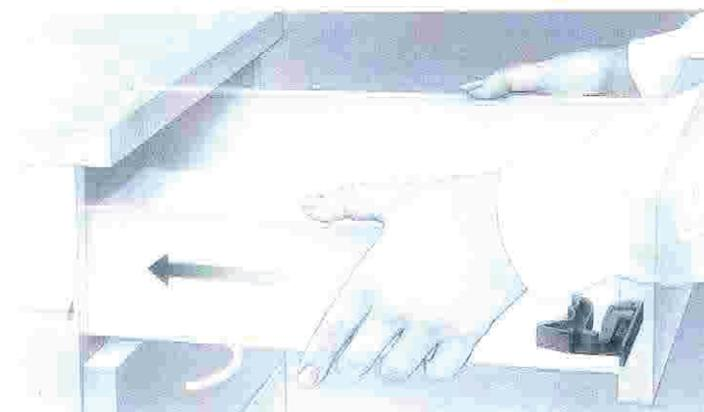
Die im Schnäpper integrierte Höhenverstellung zaubert ein perfektes Fugenbild – selbstverständlich werkzeuglos. Mit dem farblich gekennzeichneten Stellrad wird der Auflagekeil zwischen Schubkastenboden und Schiene geschoben.
