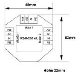
Trennrelais für zwei Motoren
