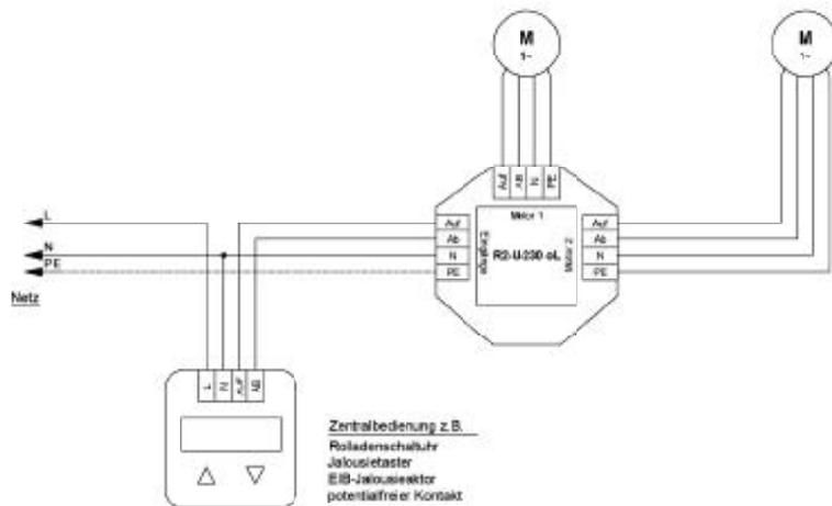
Anschlußbeispiel: Anschluß an eine Rolladenschaltuhr (oder andere Zentralbedienug)
