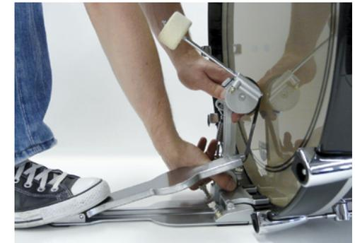
**4.12** Ziehen Sie die entriegelte Pedalsäule (J) leicht zu sich hin und nehmen Sie den Federbügel (U) von der Lagerrolle (S) des Pleuels (R). Befestigen Sie den Federbügel (U) wieder an dem dafür vorgesehenen Magneten (Z).
