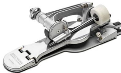
**4.1** Im Auslieferungszustand des Pedals befindet sich die Stellschraube (L) der Bass Drum Klemmung (M) in ihrer Endposition. Bitte lösen Sie zuerst die Kontermutter (K) bis unter den Vierkantschraubenkopf der Stellschraube (L), indem Sie sie gegen den Uhrzeiger- sinn nach oben drehen.
