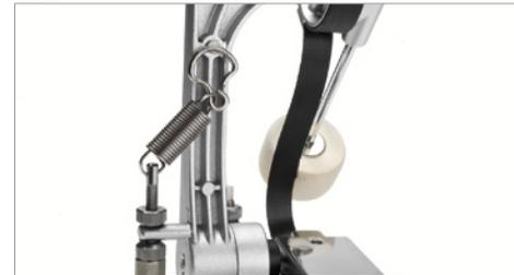
**4.6** Drehen Sie nun mit Hilfe des Vierkantschlüssels (im Lieferumfang enthalten) die Stellschraube (L) der Bass Drum Klemmung (M) im Uhrzeigersinn nach unten, bis Sie einen leichten Gegendruck spüren.
