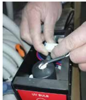
7. Schritt: Weiße Verbindungsstücke wieder verkuppeln
