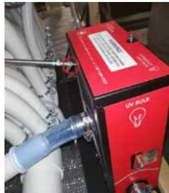
1. Schritt: Die zwei mit rot markierten Schrauben rausdrehen
