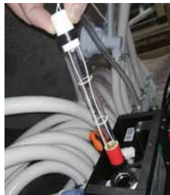
5. Schritt: UV Licht zum Wechseln rausnehmen
