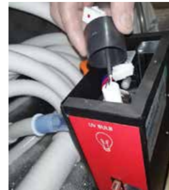
4. Schritt: Schwarze Abdeckung herausnehmen
