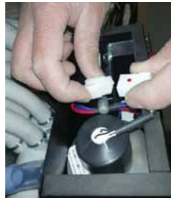
3. Schritt: Weiße Verbindungsstücke entkuppeln
