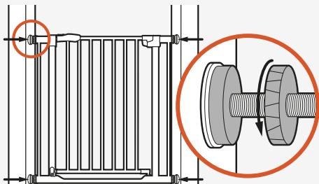
Gitter in den Durchgang platzieren & die 4 Klemmschrauben gleichmäßig fest anziehen.
