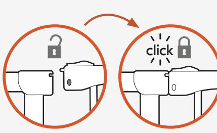
Alle Klemmschrauben nachziehen, bis die Tür gerade ist und korrekt einrastet.
