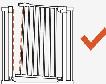
Die anfängliche Schiefstellung ist normal und verschwindet durch das Anziehen der Schrauben.
