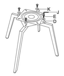
Befestigen Sie die *Montageplatte (D)* mit *4 kürzeren Schrauben (E)* zusammen mit den *Unterliegsscheiben (K)* auf dem Beinkreuz.
