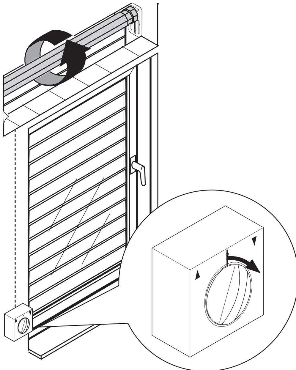
Nach Anschluss der Elektrik muss bei Befehl AB (▼) die Welle in die entsprechende Richtung drehen (s. Abb.).
