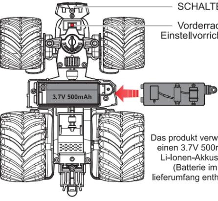
Das produkt verwendet einen 3.7V 500mAh Li-Ionen-Akkusatz (Batterie im lieferumfang enthalten)
