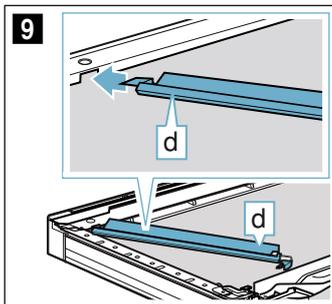
8. Reflektor **d** einsetzen (Bild 10).
