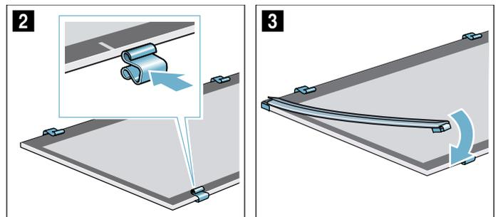
3. Zwischenscheibe mit Dichtungen und Abstandshalter einsetzen. Der Pfeil auf der Zwischenscheibe muss mit dem Pfeil auf dem Rahmen übereinstimmen (Bild 4).
