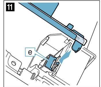
10. Zweiten Reflektor rechts wie den linken Reflektor einsetzen.
