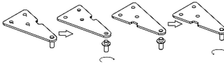
4. Setzen Sie die Tür wieder ein und bringen Sie darauf das obere Scharnier auf der linken Seite an. Achten Sie darauf, dass die Tür ordnungsgemäß ausgerichtet ist und die Dichtungen ordnungsgemäß anliegen, bevor Sie das obere Scharnier endgültig festziehen.
