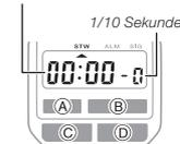
Der Stoppuhrmodus misst die abgelaufene Zeit. Der Bereich der Stoppuhr beträgt 59 Minuten, 59,9 Sekunden.
