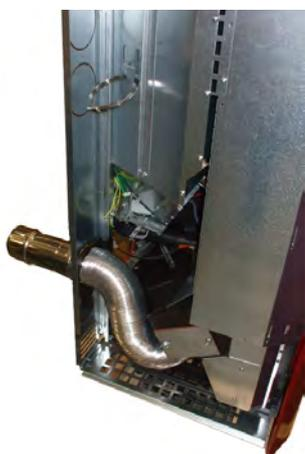
Fig. 47 - Positionierung der Rohre für hinteren Kanal
