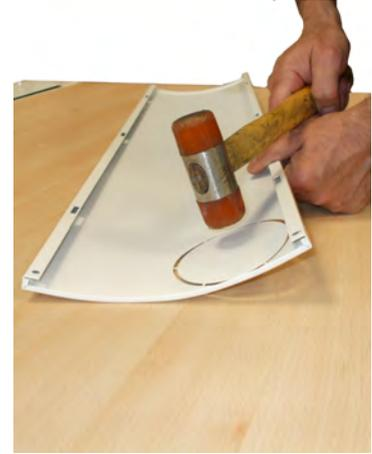
Fig. 30 - Öffnen Sie das Loch (Modell Sfera<sup>3</sup> Plus)
