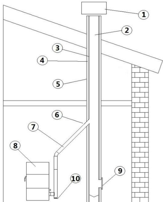
Fig. 6 - Bauteile Kamin
