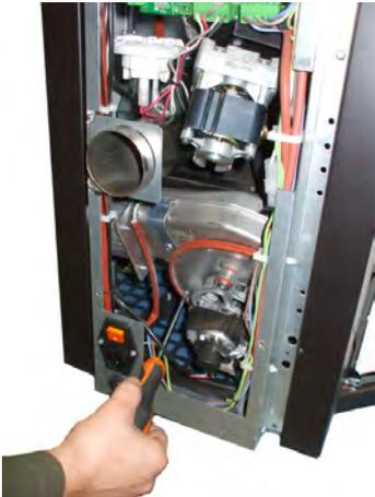
Fig. 84 - Reinigung Rauchgasansauggerät: Phase 1
