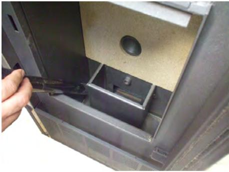
Fig. 58 - Reinigung Fach Brennschale
