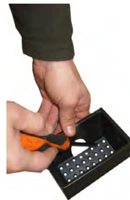
Fig. 57 - Reinigung Brennschale
