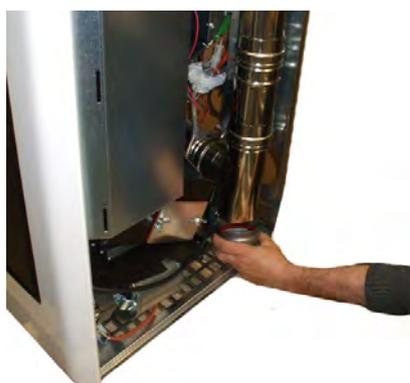
Fig. 82 - Reinigung des Rauchgaskanals
