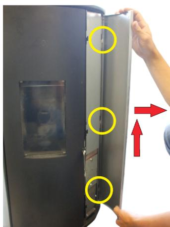
Fig. 66 - Sfera<sup>3</sup> / Sfera<sup>3</sup> Plus: Die Seitenplatten auslösen
