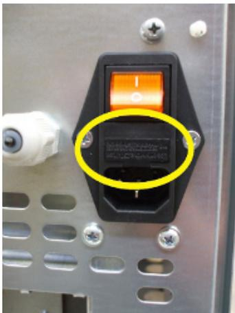
**Fig. 88** - Abdeckklappe mit Sicherungen, die ausgetauscht werden müssen
