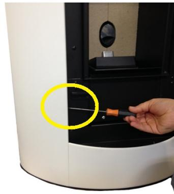
Fig. 74 - Lösen der unteren Schraube
