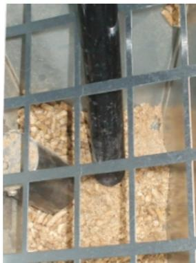
Fig. 60 - Reinigung Tank und Schnecke
