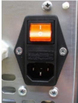
Fig. 43 - Elektrische Steckdose mit Hauptschalter
