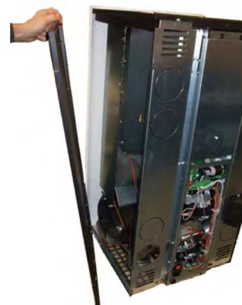
Fig. 63 - Abnehmen der Seitenwand
