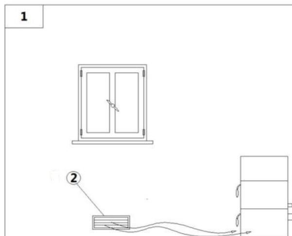
Fig. 7 - Direkte Luftzufuhr
