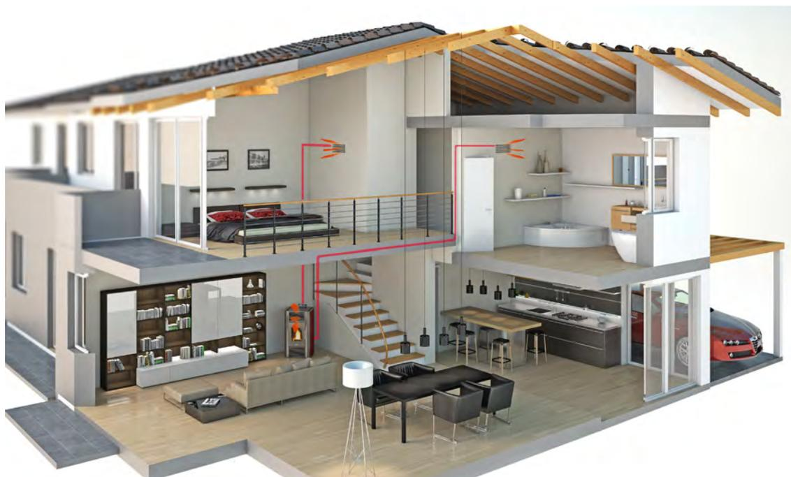
Fig. 49 - Beispiel einer Kanalisierung
