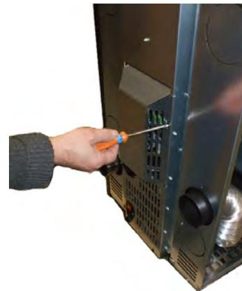
**Fig. 89** - Entfernen hinteres Gehäuse
