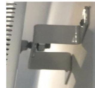
3. Anschließend schrauben Sie die Abstandshalter an die unteren Gewindebolzen auf und stellen diese entsprechend ein. Nachdem die Fixierung vorgenommen wurde, können Sie nun die Mutter M8 aus Punkt 2. festziehen.
