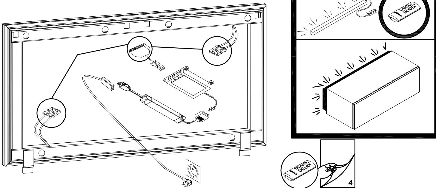
**2 Trafo / 2 piece transformator / 2 pièce de transformateur**
