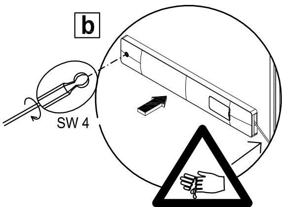
**Verletzungsgefahr, da das Seil unter einer großen Zugkraft steht.**
