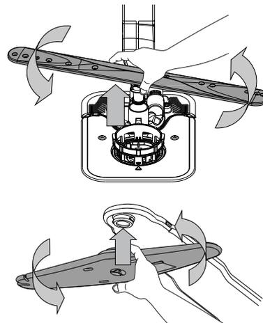
Um den unteren Sprüharm abzunehmen, diesen nach oben ziehen und gegen den Uhrzeigersinn drehen. Der Sprüharm wird wieder eingebaut, indem er nach unten gezogen und im Uhrzeigersinn gedreht wird.
