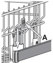
**Klappbare Klappen mit verstellbarer position**
